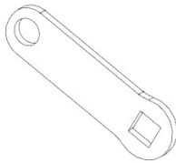
F04 LINKAGE STRAP - A4M02225 (x1) 1/8"x13/16"x2 5/8" (3x20x66)
