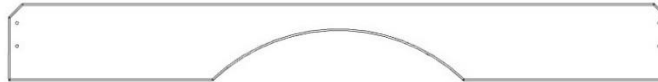
G1 LINTEAU AVANT - W4L17330 (x1) 15/16 po x 5 1/4 po x 44 15/16 po (24 x 134 x 1 142)
