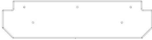
L1 FENÊTRE - W4L17328 (x1) 5/8 po x 4 7/16 po x 17 5/8 po (16 x 112 x 448)
