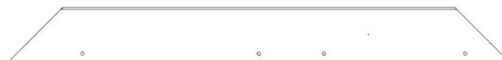
M6 ENCADREMENT DU PIGNON - W4L17355 (x2) 5/8 po x 3 3/8 po x 30 1/2 po (16 x 86 x 774)
