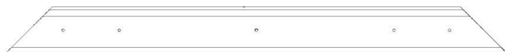
K902 PLANCHE DE RIVE DU PIGNON - W4L17352 (x2) 7/16 po x 3 3/8 po x 36 3/4 po (11 x 86 x 933)
