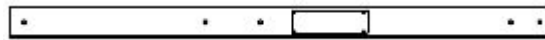
E2 | MONTANT AVANT DROIT - W2A03764 (x1) | 1 3/8 po x 3 3/8 po x 62 3/8 po (36 x 86 x 1 584)
