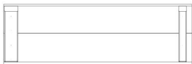
RP1 PANNEAU DE TOITURE DU SOMMET DU PORCHE GAUCHE - W2A02650 (1) 1 5/8"x10 1/2"x32 7/8" (42x268x834)
