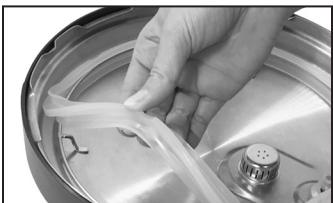
7. Tire de la tapa antibloqueo. Ésta se encuentra sujetada con clips de tensión (no roscada). Mantenga sus dedos alejados de los clips. La tapa será difícil de retirar la primera vez.
