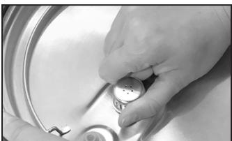
8. Retire el sellador de la válvula flotante (1) mientras sujetla la válvula flotante desde el otro lado de la tapa. Luego retire la válvula flotante (2).
