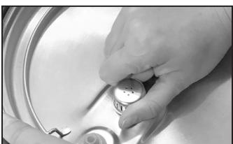
8. Retirer le joint d'étanchéité de la soupape à flotteur (1) tout en soutenant la soupape à flotteur de l'autre côté du couvercle. Retirer ensuite la soupape à flotteur (2).
