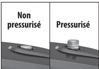
**Remarque :** Ne jamais tenter d'ouvrir le couvercle pendant la cuisson sous pression. Si le couvercle doit être ouvert pendant la cuisson, appuyer sur le bouton « STOP » (arrêt) Ø
