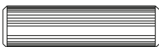
D Wooden dowel/Clavija de mad Manchon en bo isera X 6 (Ø8 X 30MM)
