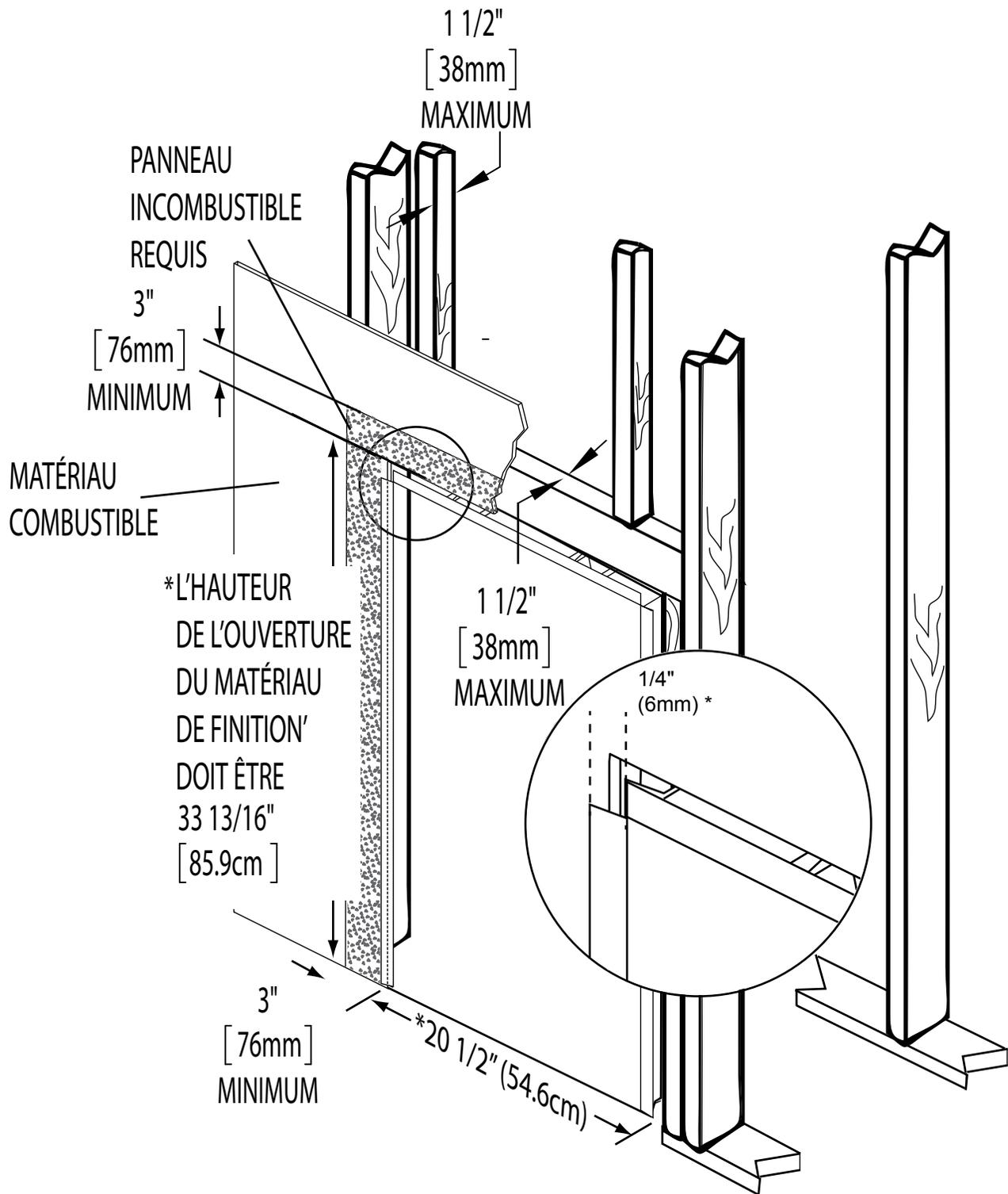
\* Le matériau de finition NE JAMAIS être installer à l'arrière de la bride de finition.
