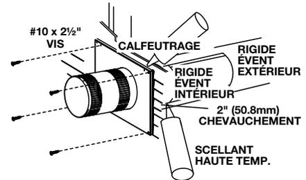
**La plaque de montage de la terminaison ne doit pas être enchâssée dans un mur ou un parement à une profondeur excédant celle de la bride.**
