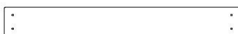
M07 | PLANCHE DE MUR - W4L13951 (x12) | 5/8 po x 3 3/8 po x 26 5/8 po (16 x 86 x 677)
