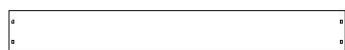
M09 | PLANCHE DE MUR D'ESCALADE - W4L13920 (x1) | 5/8 po x 3 3/8 po x 26 1/4 po (16 x 86 x 668)
