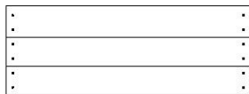
RP2 PANNEAU DE TOIT - W2A03082 (x2) 1 5/8 po x 15 5/8 po x 43 1/16 po (41 x 397 x 1 094)
