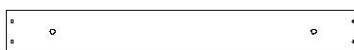
M10 | PLANCHE DE MUR D'ESCALADE - W4L13948 (x1) | 5/8 po x 3 3/8 po x 27 5/8 po (16 x 86 x 702)
