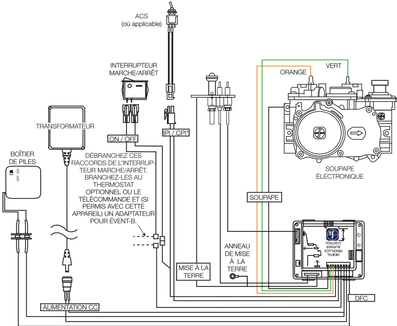
S'IL Y A LIEU, LES APPAREILS AVEC LES ADAPTATEURS POUR EVENT-B DOIVENT AVOIR L'INTERRUPTEUR D'ÉCOULEMENT BRANCHÉ EN SÉRIE AVEC L'INTERRUPTEUR ACTUEL OU L'INTERRUPTEUR MURAL OPTIONNEL, LE THERMOSTAT OU LE SYSTÈME DE TÉLÉCOMMANDE.
