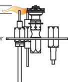
La flamme doit envelopper la sonde de flamme de 3/8" à 1/2" (9.5mm - 12.7mm)
