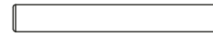
(F) Metal Pin/ Pin en métal/ Aguja de metal X 1 (Ø4 X 30MM)
