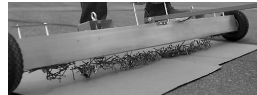
La vitesse recommandée est de jusqu'à 8 km/h, selon les conditions de la surface à balayer. Plus l'opérateur se déplace rapidement, moins la balayeuse attirera de débris. La garde au sol recommandée est d'environ 2 à 3 pouces (5,08 cm-7,62 cm). Évitez de heurter excessivement les surfaces dures car cela pourrait endommager la balayeuse.
