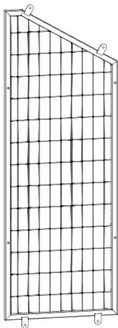
MP03 PANNEAU MÉTALLIQUE - A4M02617 (x1) 1 1/16"X20 1/2"X57 15/16" (27.4x520x1472)
