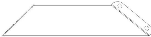
D05 CORBEAU - A4M01831 (x1) 2 3/4 po x 5 7/8 po x 24 13/16 po (70x149x631)
