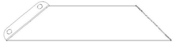
D06 CORBEAU - A4M01832 (x1) 2 3/4 po x 5 7/8 po x 24 13/16 po (70x149x631)
