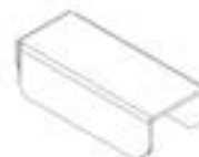
A5 SHELF BRACKET - A4M03141 (x8) 5/8"x7/8"x2 1/16" (16x22x53)
