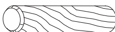
11 WOOD DOWEL/ SERVIETTE EN BOIS/ CLAVIJA DE MADERA x 18 (Ø8 X 30MM)
