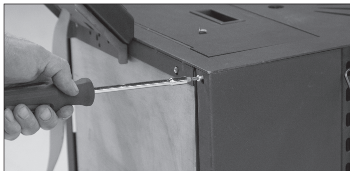
Figure 35 : Retirer les (2) vis de l'arrière du panneau latéral, en haut et en bas du panneau. Retirer les (2) vis de la face avant du panneau latéral, en haut et en bas du panneau.
