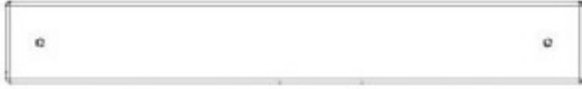
N05 BUTÉE DE FENÊTRE - W4L18811 (x2) 5/8 PO X 2 3/8 PO X 16 9/16 PO (16X60X420)
