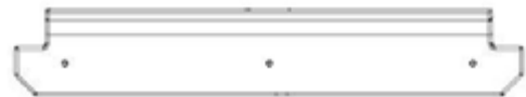
E02 PANNEAU DE REBORD - W4L18694 (x2) 1 7/16 po x 3 3/8 po x 19 15/16 po (36x86x507)
