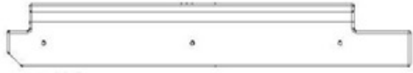
E17 PANNEAU DE REBORD - W4L18723 (x1) 1 7/16 po x 3 3/8 po x 21 3/4 po (36x86x553)
