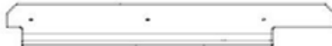
E12 PANNEAU DE REBORD - W4L18718 (x1) 1 7/16 po x 3 3/8 po x 26 1/4 po (36x86x666)
