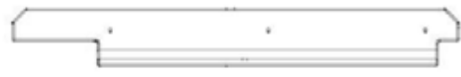
E19 PANNEAU DE REBORD - W4L18725 (x1) 1 7/16 po x 3 3/8 po x 26 1/4 po (36x86x666)
