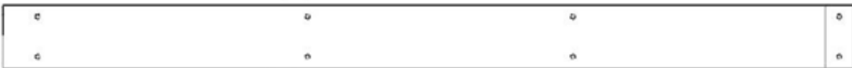
D01 PANNEAU DE LA BASE - W4L18684 (x1) 1 7/16 po x 5 1/4 po x 71 3/4 po (36 x 134 x 1 822)
