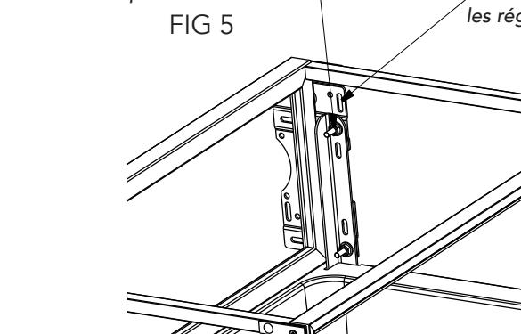
Utilice ranuras verticales para el ajuste vertical de la puerta.
