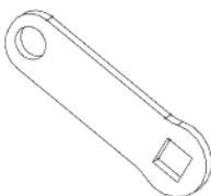
F04 SANGLE DE LIAISON - A4M02225 (x1) 1/8"x13/16"x2 5/8" (3x20x66)
