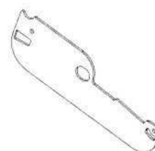
L03 PLAQUE LATÉRALE À PERSIENNES - A4M04138 (x59) 1/16"x2 3/16"x6 9/16" (2x55x167)
