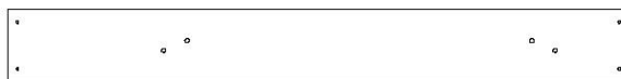
G06 | PLANCHE DE MUR D'ESCALADE - W4L16445 (x4) | 1 po x 5 1/4 po x 44 5/8 po (24 x 134 x 1135)
