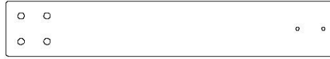
H83 | CALE DE TOBOGGAN - W4L13333 (x2) 1 po x 3 3/8 po x 20 1/8 po (24 x 86 x 512)
