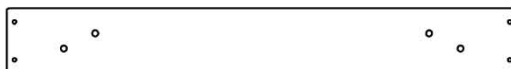
M76 | PLANCHE DE MUR D'ESCALADE - W4L16073 (x4) 5/8 po x 3 3/8 po x 26 5/8 po (16 x 86 x 675)
