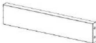
H8 POUTRE - A4M05149 (x4) 16 5/16 po x 3 3/8 po x 1 po (25 x 85 x 414,5)
