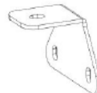
J7 SUPPORT DE CHEVRON - A4M05207 (x9) 3 5/8 po x 2 3/16 po x 2 po (50 x 55 x 92)
