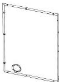
G5 ASSEMBLAGE DU PANNEAU ARRIÈRE - A4M06924 (x1) 33 3/8 po x 25 po x 1 3/16 po (30 x 634,7 x 848)
