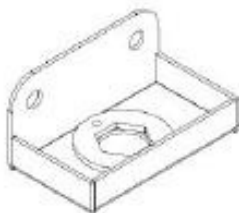
A9 ASSEMBLAGE DU PORTE-TUYAU - A4M03060 (x1) 1 1/4 po x 1 7/16 po x 2 9/16 po (31,5 x 36,5 x 65)
