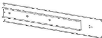
A10 ASSEMBLAGE DU SUPPORT À GLISSIÈRE - A4M03083 (x4) 15/16 po x 3 3/8 po x 22 5/8 po (23 x 85 x 575)
