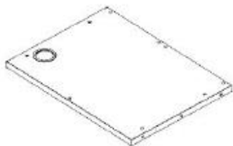
T4 ASSEMBLAGE DU DESSUS DE TABLE - A4M05131 (x1) 31 7/16 po x 23 3/8 po x 1 1/4 po (32 x 593 x 799)
