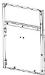
S1 ASSEMBLAGE DU PANNEAU LATÉRAL - A4M05116 (x1) 33 3/8 po x 23 3/8 po x 1 3/8 po (35,00 x 594,00 x 848)
