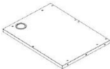
T6 ASSEMBLAGE DU DESSUS DE TABLE - A4M05162 (x1) 31 7/16 po x 23 3/8 po x 32 (32 x 593 x 799)
