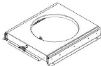
A13 ASSEMBLAGE DU SUPPORT DE RÉSERVOIR D'ESSENCE - A4M03047 (x3) 1 15/16 po x 12 7/8 po x 14 3/4 po (49 x 327 x 374)
