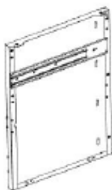
S5 ASSEMBLAGE DU PANNEAU LATÉRAL - A4M05135 (x1) 33 3/8 po x 23 3/8 po x 35 (50 x 594 x 848)
