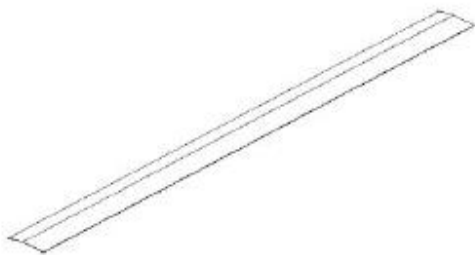
5655 BORD D'ÉGOUTTAGE - A4M05655 (x1) 41 1/8 po x 3 5/16 po x 3/16 po (4 x 84 x 1044)
