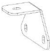
J7 SUPPORT DE CHEVRON - A4M05207 (x9) 3 5/8 po x 2 3/16 po x 2 po (50 x 55 x 92)
