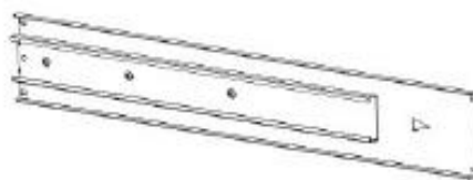
A10 ASSEMBLAGE DU SUPPORT À GLISSIÈRE - A4M03083 (x2) 15/16 po x 3 3/8 po x 22 5/8 po (23 x 85 x 575)
