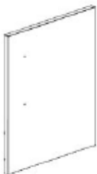
D1 ASSEMBLAGE DE LA PORTE - A4M05143 (x1) 25 3/16 po x 19 3/4 po x 15/16 po (24 x 501 x 639)
