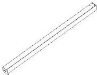
P03 ASSEMBLAGE DU POTEAU AVANT - A4M05182 (x1) 4 3/4 po x 4 3/4 po x 96 7/8 po (2461 x 120 x 120)
