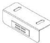
A2 SUPPORT À AIMANT - A4M03026 (x2) 1 po x 1 1/4 po x 3 1/8 po (25 x 31 x 80)
