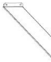
C02 ASSEMBLAGE DE CORBEAU - A4M05206 (x1) 28 1/16 po x 1 7/16 po x 7 3/4 po (197 x 36 x 713)
