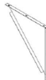
A11 PANNEAU TRIANGULAIRE - A4M03086 (x4) 13/16 po x 13 3/4 po x 13 3/4 po (20 x 350 x 350)
