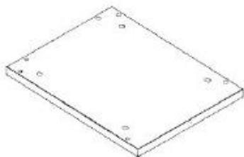
T1 PANNEAU DE DESSUS DE TABLE - A4M05137 (x1) 18 3/8 po x 24 1/8 po x 1 1/4 po (32 x 612 x 467,50)
