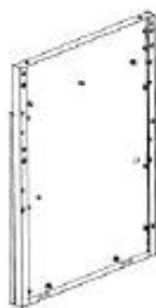
S9 ASSEMBLAGE PANNEAU LATÉRAL - A4M05130 (x1) 33 3/8 po x 23 3/8 po x 1 3/8 po (35 x 594 x 848)
