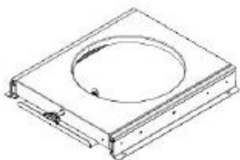
A13 ASSEMBLAGE DU SUPPORT DE RÉSERVOIR D'ESSENCE - A4M03047 (x1) 1 15/16 po x 12 7/8 po x 14 3/4 po (49 x 327 x 374)
