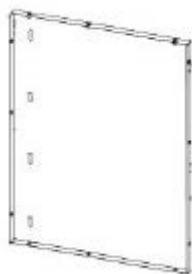
G1 ASSEMBLAGE DU PANNEAU ARRIÈRE - A4M06926 (x1) 33 3/8 po x 25 1/16 po x 1 3/16 po (30 x 636,5 x 848)
