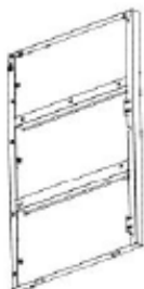
S3 ASSEMBLAGE DU PANNEAU LATÉRAL - A4M05117 (x1) 33 3/8 po x 23 3/8 po x 1 3/8 po (35 x 594 x 848)
