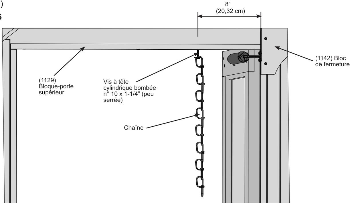
**F** : Mesurez 5" (12,7 cm) à partir de l'extrémité du (1175) panneau de porte, puis fixez le support à chaîne avec deux vis à tête cylindrique bombée n° 10 x 1-1/4". (F25.6 et F25.7)
