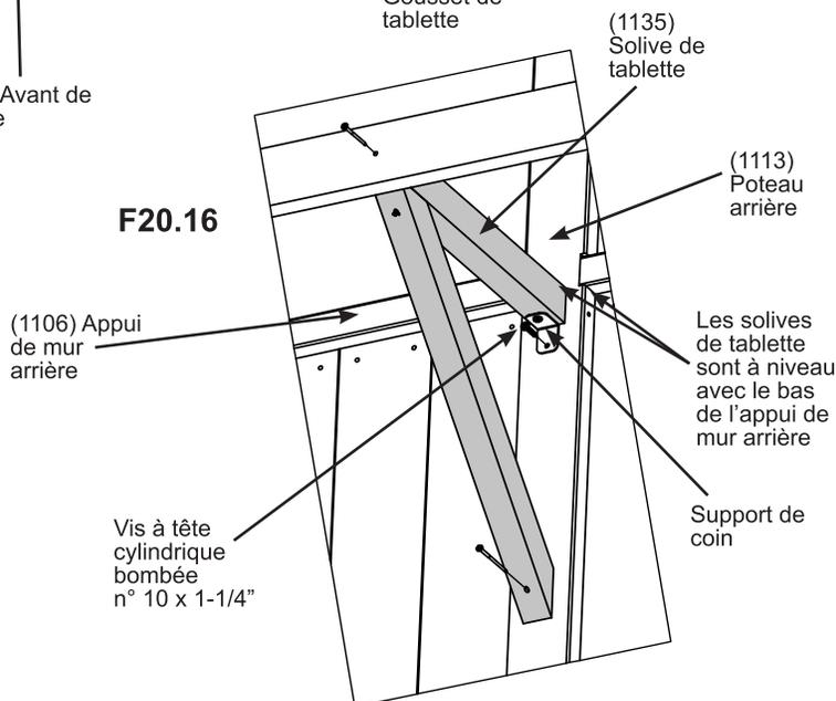
Les solives de tablette sont à niveau avec le bas de l'appui de mur arrière
