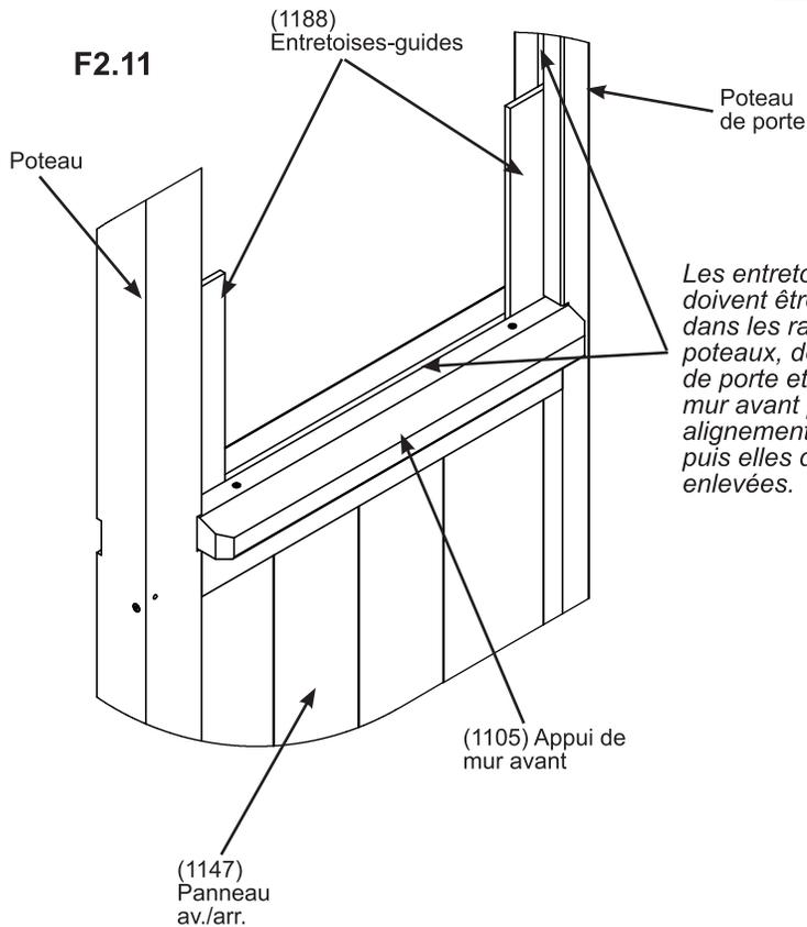
*Les entretoises-guides doivent être insérées dans les rainures des poteaux, des poteaux de porte et de l'appui de mur avant pour un bon alignement des poteaux, puis elles doivent être enlevées.*
