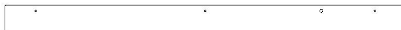
M13 | PLANCHE D'ANGLE ARRIÈRE - W4L16904 (x1) | 5/8 po x 3 3/8 po x 51 po (16x86x1297)
