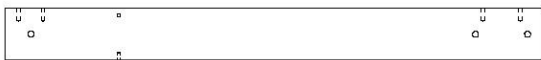
E4 | MONTANT ARRIÈRE GAUCHE - W4L16908 (x1) | 1 3/8 po x 3 3/8 po x 35 po (36x86x889)
