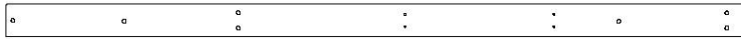
H7 | LISSE DE PLANCHER - W4L06436 (x1) | 1 po x 3 3/8 po x 76 7/8 po (24x86x1952)
