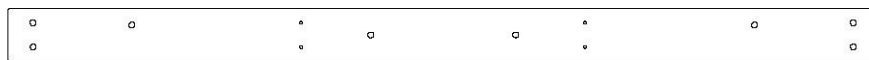
H1 | LISSE DE PLANCHER - W4L06391 (x1) | 1 po x 3 3/8 po x 56 3/4 po (24x86x1442)
