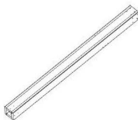
P02 POTEAU - W2A04717 (x2) 6 po x 6 po x 89 1/2 po (152 x 152 x 2274)
