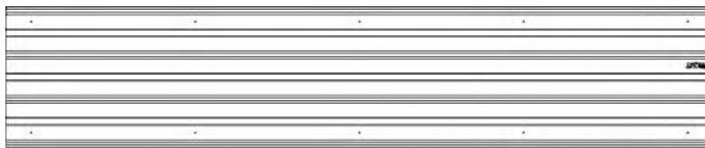
3528 TÔLE EN ACIER - A4M03528 (x8) 87"x18 7/8"x1/4" (7x480x2210)
