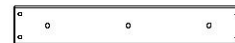
M70 | SOPORTE DE LA BASE DEL TOBOGÁN: W100935 (x1) | 5/8"x3 3/8"x19 7/8" (16x86x505)
