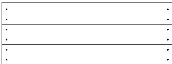
RP3 | PANNEAU DE TOIT - W2A03135 (x2) | 1 5/8 po x 15 5/8 po x 43 1/16 po (42 x 397 x 1 094)
