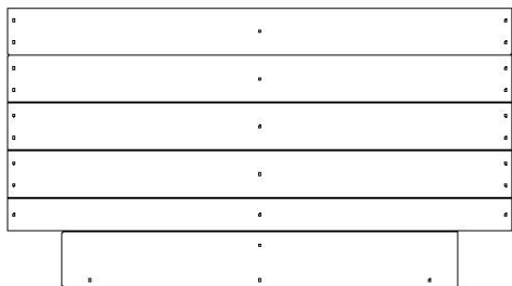
HH1 | PANNEAU DE PLANCHER - W2A03079 (x2) | 1 1/4 po x 20 1/8 po x 36 3/8 po (32 x 510 x 924)
