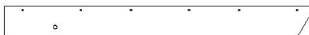
H09 | LISSE DE TOIT - W4L16455 (x4) | 1 po x 3 3/8 po x 34 1/2 po (24 x 86 x 877)
