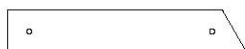
H02 LISSE DE PLANCHER - W4L16429 (x2) 1 po x 3 3/8 po x 18 3/4 po (24x86x477)
