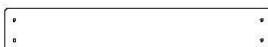
M02 | PLANCHE DE MUR D'ESCALADE - W4L16436 (x8) | 5/8 po x 3 3/8 po x 20 7/8 po (16 x 86 x 529)
