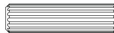
(G) Wooden dowel/ Clavija de madera/ Manchon en bois X 4 (ø8 X 30mm)
