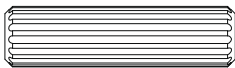
F Wooden dowel/ Clavija de madera/ Manchon en bois X 10 (ø8 X 30mm)
