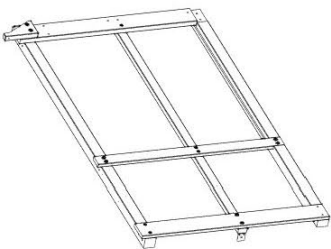
MONTAJE DE LA PARED FRONTAL DEL PASO 16
