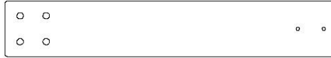
H83 CALE DE TOBOGGAN - W4L13333 (x2) 1 po x 3 3/8 po x 20 1/8 po (24x86x512)
