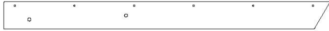
H10 LISSE DE TOIT - W4L16147 (x2) 1 po x 3 3/8 po x 39 7/8 po (24x86x1014)
