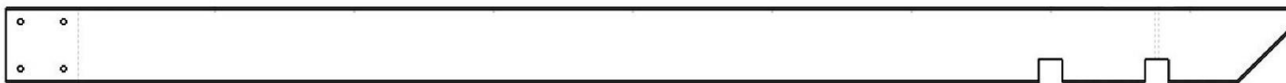
D15 | SOLIVE À FENTE - W4L15517 (8) | 1 3/8 po x 5 1/4 po x 89 1/2 po (36 x 134 x 2 274)
