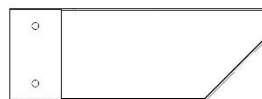
D04 | EXTRÉMITÉ DE SOLIVE - W4L15503 (2) | 1 3/8 po x 5 1/4 po x 15 po (36 x 134 x 382)
