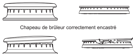
Chapeau de brûleur incorrectement installé
