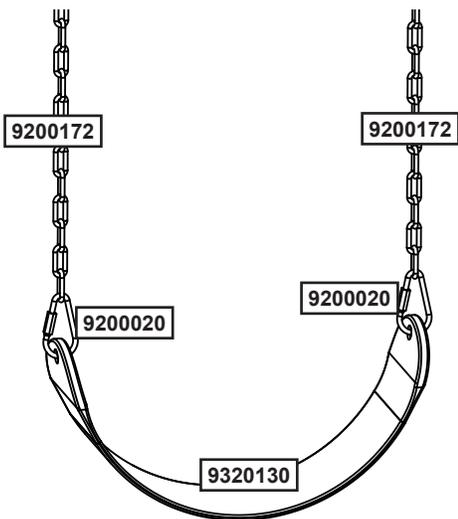
**Precaución:** Los mosquetones con rosca se deben instalar con la abertura completamente hacia abajo, cubriendo las roscas, y deben apretarse según se indica.
