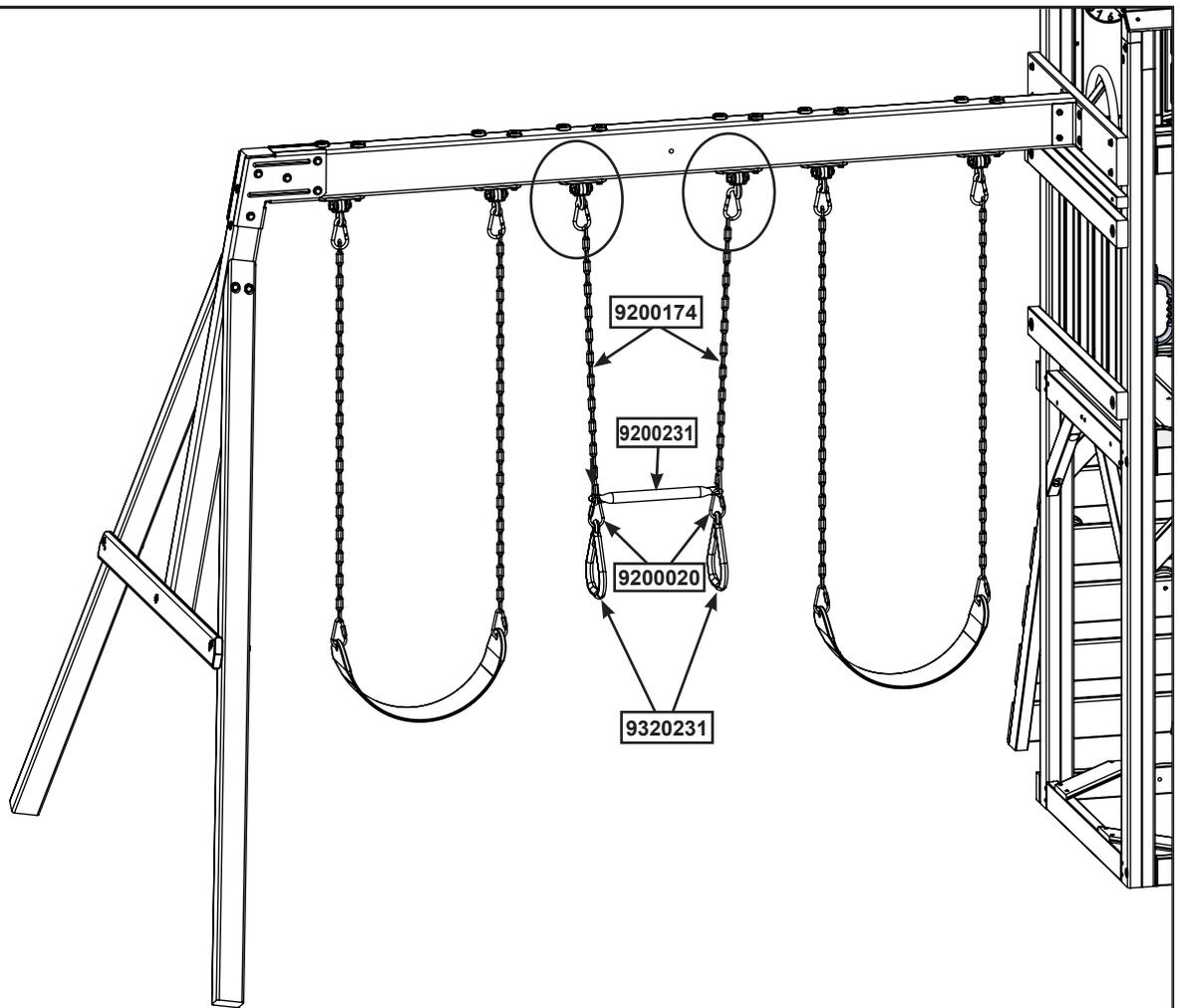
**Precaución:** Los mosquetones con rosca se deben instalar con la abertura completamente hacia abajo, cubriendo las roscas, y deben apretarse según se indica.
