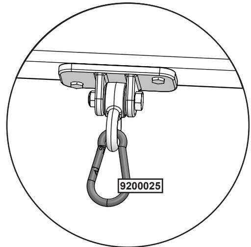
**Precaución:** El mosquetón con resorte debe ir fijado al soporte para columpio de gran resistencia en posición cerrada.
