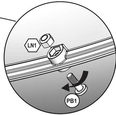
Retire el perno de cabeza alomada (PB1) de 1/4 x 3/4" (6,4 x 19,1 mm). El perno (PB1) ya no lo va a necesitar, pero debe guardar la tuerca de retención (LN1)
