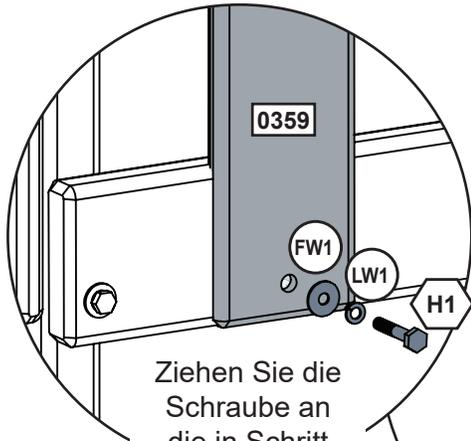
Ziehen Sie die Schraube an die in Schritt 12A befestigte Einschlagmutter fest.
