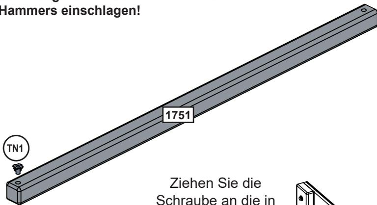
Ziehen Sie die Schraube an die in Schritt 7B befestigte Einschlagmutter fest.
