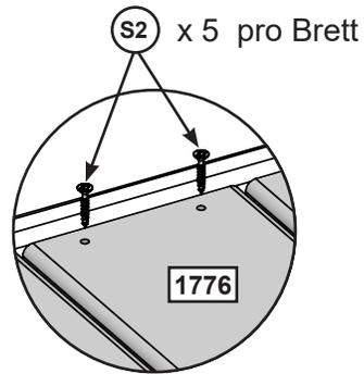
Bringen Sie in diesem Schritt noch keine Schraube in diesem Loch an.
