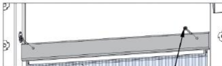
P04 SOLIN DE TÊTE DE FENÊTRE - W4L20942 (x2) 1 7/16 po x 1 7/16 po x 15 3/4 po (36x36x400)
