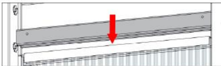
P05 SOLIN DE TÊTE DE FENÊTRE - W4L20943 (x2) 1 7/16 po x 1 7/16 po x 18 7/16 po (36x36x468)
