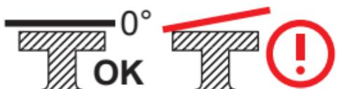
**ATTENTION:** Vérifiez que la **PLAQUE DE BASE RÉGLABLE** n'est pas installée en dessous de la surface du boîtier du viseur car le montage manquerait alors de solidité.
