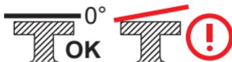
**WARNUNG:** Stellen Sie sicher, dass die **VERSTELLBARE BASISPLATTE** nicht unterhalb der Oberfläche des Visiergehäuses angebracht ist, da dies keinen sicheren Halt garantiert.
