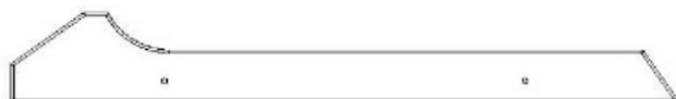
M33 | BORDURE DE TOIT - W4L14957 (x2) | 5/8 po x 3 3/8 po x 25 5/8 po (16 x 86 x 652)
