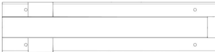
OG08 PLANCHE DU PASSAGE DE CÂBLES - W4L22040 (x1) 1 3/16 po x 3 3/8 po x 14 7/16 po (30 x 86 x 367)
