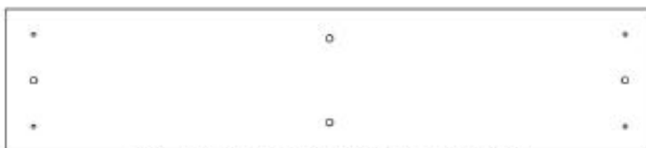
Y01 (x2) PLANCHE DE PROTECTION DU CHAUFFE-SAUNA - W4L22601 5/8 po x 4 po x 18 1/4 po (16 x 102 x 464)
