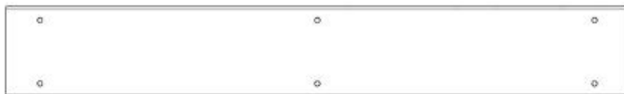
OG04 TASSEAU DE SIÈGE - W4L21951 (x2) 1 3/16 po x 3 3/8 po x 23 1/16 po (30 x 86 x 586)
