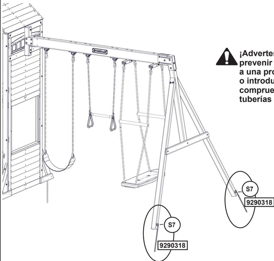
**¡Advertencia!** A fin de evitar que la estructura vuelque y prevenir posibles lesiones, las estacas deben clavarse a una profundidad de 330 mm (13"). Clavar las estacas o introducirlas en el suelo puede ser peligroso si no se comprueba antes la ausencia de conductores, cables o tuberías de gas subterráneos.
