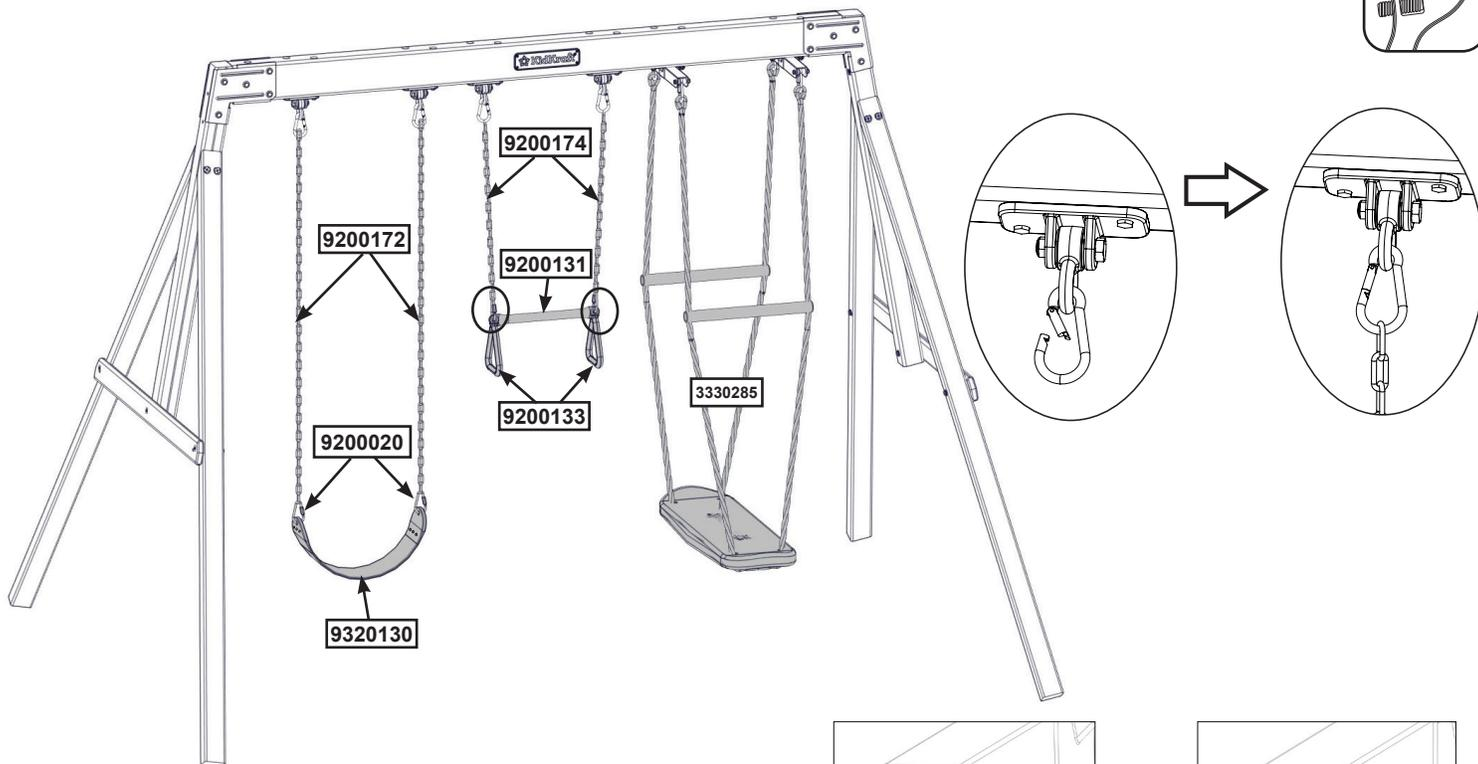
**Precaución:** Los mosquetones con rosca se deben instalar con la abertura completamente hacia abajo, cubriendo las roscas, y deben apretarse según se indica.
