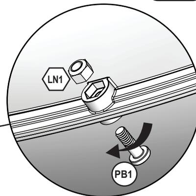
Retire el perno de cabeza alomada (PB1) de 6.3 mm x 19.1 mm (1/4 x 3/4"). El perno (PB1) ya no lo va a necesitar, pero debe guardar la tuerca de retención (LN1)
