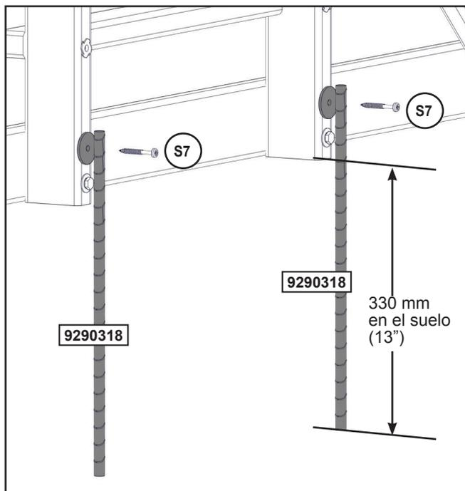
**¡Advertencia!** A fin de evitar que la estructura vuelque y prevenir posibles lesiones, las estacas deben clavarse a una profundidad de 330 mm (13"). Clavar las estacas o introducirlas en el suelo puede ser peligroso si no se comprueba antes la ausencia de conductores, cables o tuberías de gas subterráneos.
