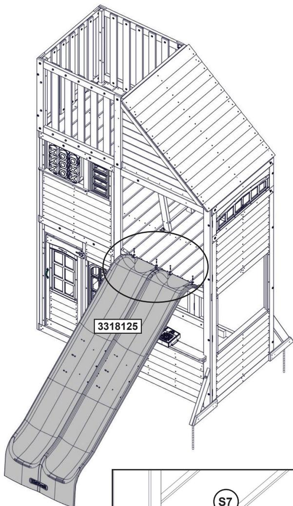
**Nota:** Pretaladre todos los orificios con una broca de 3 mm (1/8") antes de instalar los tornillos de cabeza alomada.
