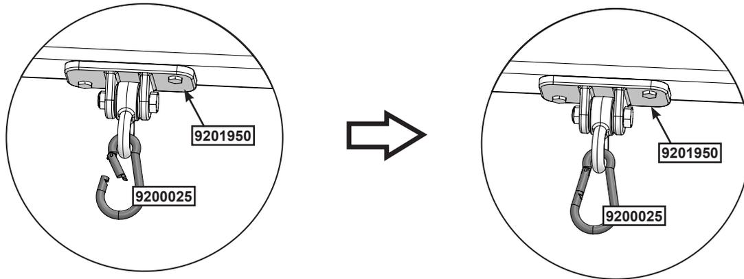
**Precaución:** El mosquetón con resorte debe ir fijado al soporte para columpio de gran resistencia en posición cerrada.
