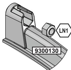
**Nota: El juego inferior de abrazaderas puede girarse 90° para instalar los pernos y que el montaje resulte más sencillo.**
