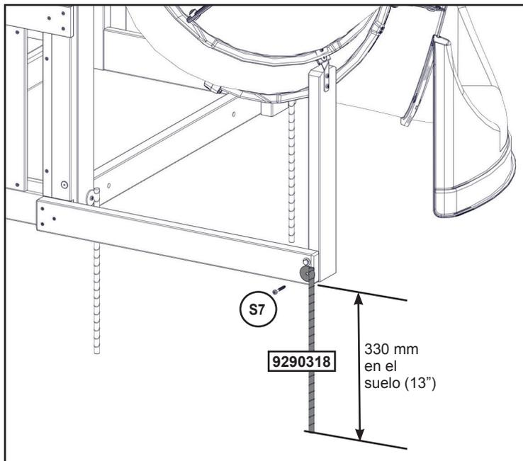
**!** ¡Advertencia! A fin de evitar que la estructura vuelque y prevenir posibles lesiones, las estacas deben clavarse a una profundidad de 330 mm (13"). Clavar las estacas o introducirlas en el suelo puede ser peligroso si no se comprueba antes la ausencia de conductores, cables o tuberías de gas subterráneos.
