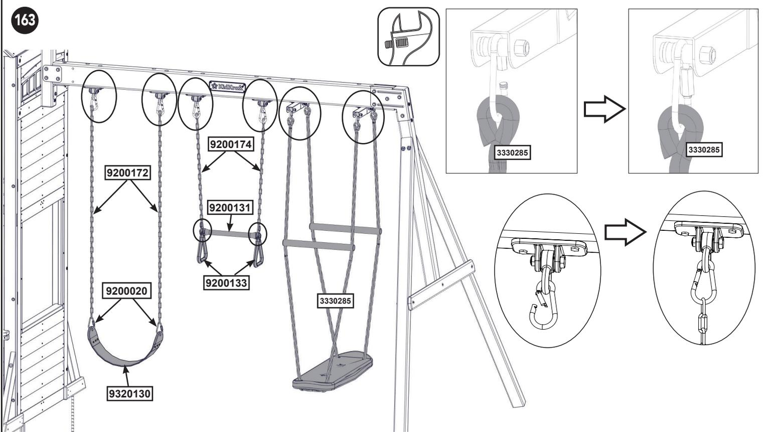
**Precaución:** Los mosquetones con rosca se deben instalar con la abertura completamente hacia abajo, cubriendo las roscas, y deben apretarse según se indica.
