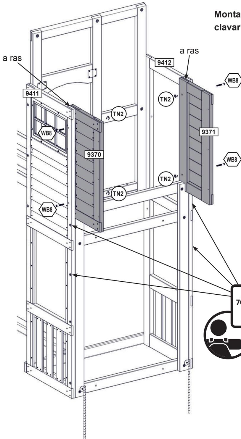
Afloje los herrajes WL5 de los pasos 70 y 71 para completar el paso. Vuelva a apretar los herrajes cuando haya completado el paso.
