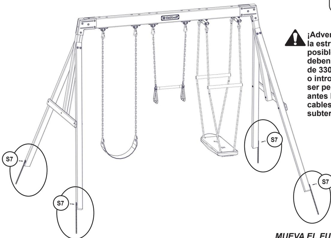
**¡Advertencia!** A fin de evitar que la estructura vuelque y prevenir posibles lesiones, las estacas deben clavarse a una profundidad de 330 mm (13"). Clavar las estacas o introducir las en el suelo puede ser peligroso si no se comprueba antes la ausencia de conductores, cables o tuberías de gas subterráneos.
