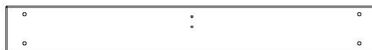
G4 | PLANCHE DE MUR - W4L13181 (x1) | 1 po x 5 1/4 po x 42 1/2 po (24 x 134 x 1080)
