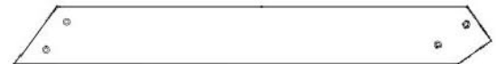
B09 ASSEMBLAGE DE BRAS DE PIGNON - A4M03515 (x2) 40 1/16 po x 5 1/4 po x 1 7/16 po (36 x 134 x 1 017)
