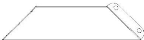
C02 ASSEMBLAGE D'ENCORBÈLEMENT — A4M03526 (x1) 21 13/1 114 po X 2 3/4 po (70 X 134 X 553,5)
