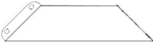
C01 ASSEMBLAGE D'ENCORBELLEMENT — A4M03525 (x1) 21 13/16 po x 5 1/4 po x 2 3/4 po (70 x 134 x 553,5)
