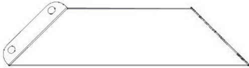
C01 ASSEMBLAGE D'ENCORBLEMENT — A4M03525 (x1) 21 13/16 po x 5 1/4 po x 2 3/4 po (70 x 134 x 553,5)
