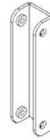
J4 SUPPORT DE POUTRE — A4M02990 (x2) 1-x1 5/16 po x 5 1 1/16 po (25 x 33,2 x 128)
