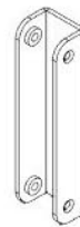
J4 SUPPORT DE POUTRE — A4M02990 (x2) 1 po x 1 5/16 po x 5 1 1/16 po (25 x 33,2 x 128)
