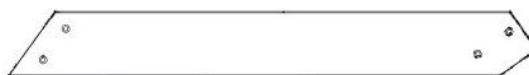
B09 ASSEMBLAGE DE BRAS DE PIGNON — A4M03515 (x2) 40 1 116 po x 5 1/4 po x 1 7/16 po (36 x 134 x 1 017)
