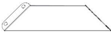
C01 ASSEMBLAGE D'ENCORBELLEMENT - A4M03525 (x4) 21 13/16 po x 5 1/4 po x 2 3/4 po (70 x 134 x 553,5)
