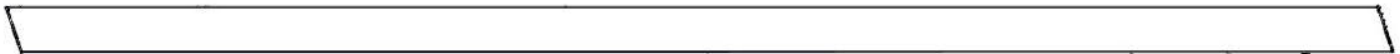
R03 ASSEMBLAGE DE CHEVRON - A4M03524 (x4) (x4) 86 3/8 po x 4 5/16 po x 3 1/8 po (80 x 110 x 2 194,6)
