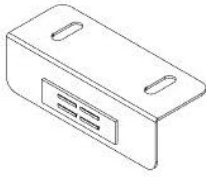
A2 SUPPORT D'AIMANT — A4M03026 (x1) 1 po x 1 1/4 po x 3 1/8 po (25 x 31 x 80)
