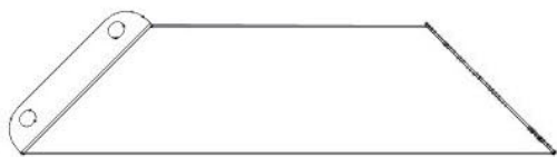
C01 ASSEMBLAGE D'ENCORBLEMENT — A4M03525 (x1) 21 13/16 po x 5 1/4 po x 2 3/4 po (70 x 134 x 553,5)
