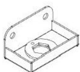
A9 ASSEMBLAGE DE SUPPORT DE TUYAU —A4M03060 (x1) 1 1/4 po x 1 7/16 po x 2 9/16 po (31,5 x 36,5 x 65)
