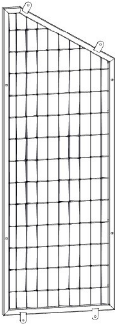
MP03 PANNEAU MÉTALLIQUE - A4M02617 (x1) 1 1/16"X20 1/2"X57 15/16" (27.4x520x1472)
