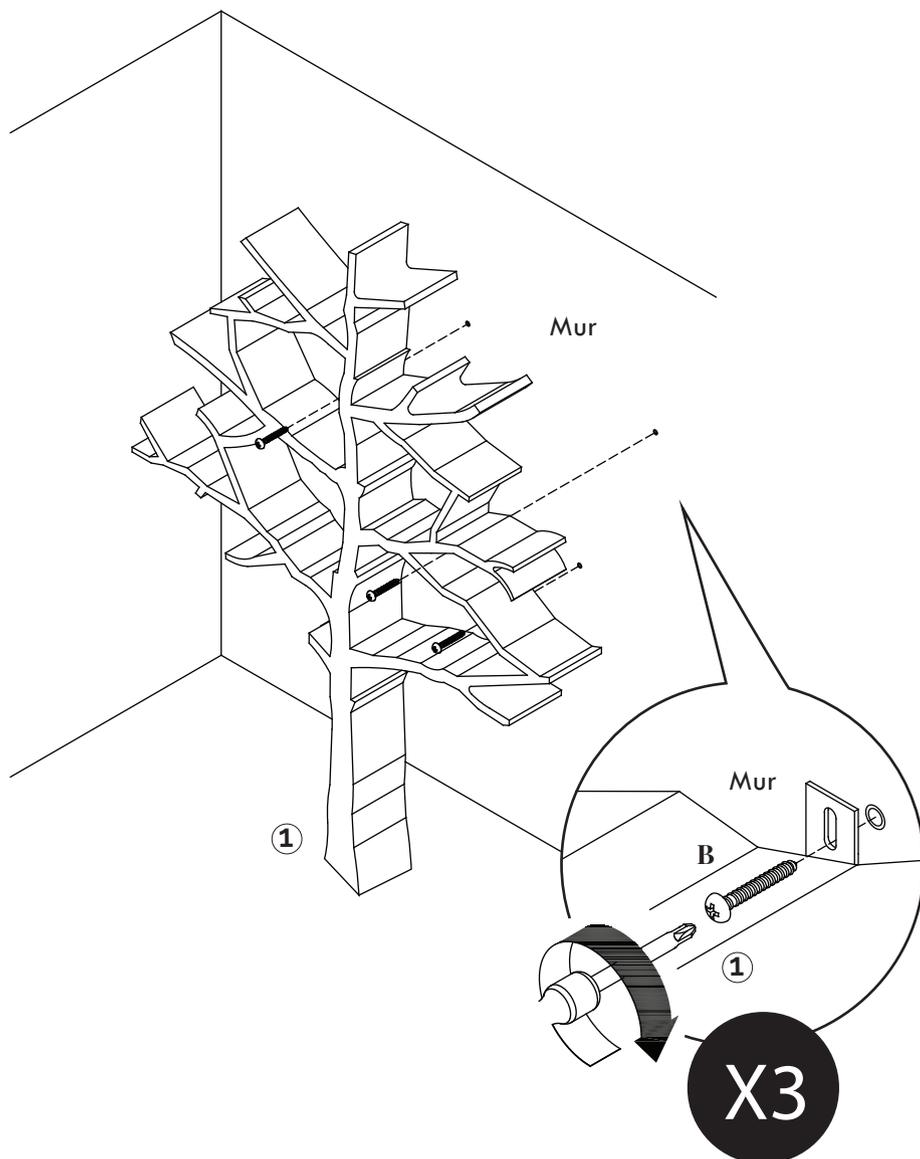
Appuyer de nouveau l'arbre-bibliothèque ① contre le mur et fixer les plaques métalliques avec les vis B à l'aide d'un tournevis cruciforme (non fourni).
