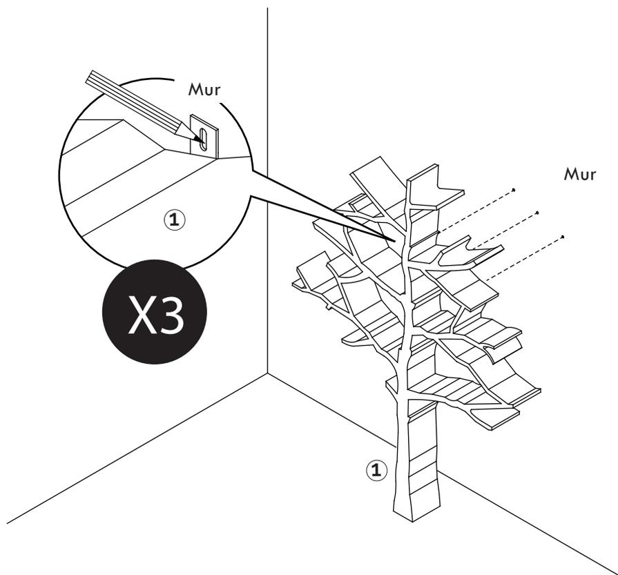
Placer l'arbre-bibliothèque ① contre un mur. S'assurer que la zone d'installation est propre. Marquer la position des plaques métalliques sur le mur.
