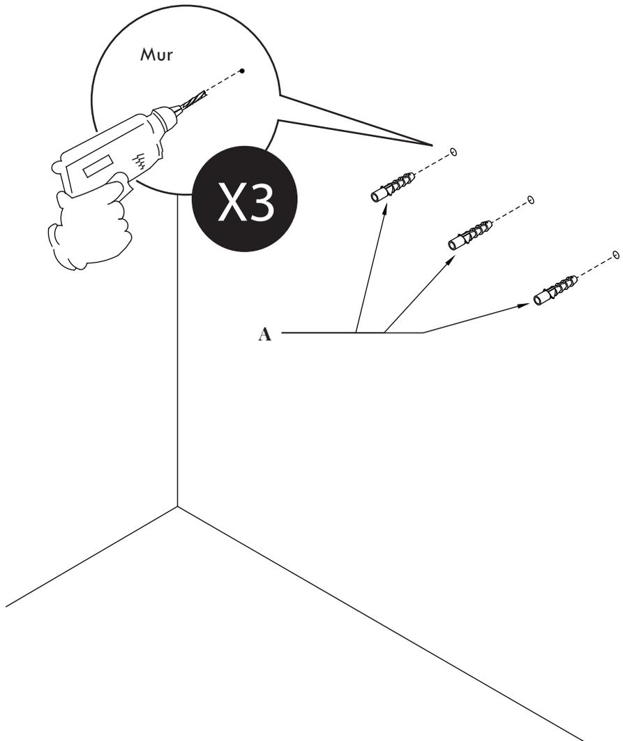
À l'aide d'une perceuse électrique (non fournie), percer les trois trous aux endroits marqués. Insérer les chevilles d'ancrage **A** dans les trous avec un marteau (non fourni).
