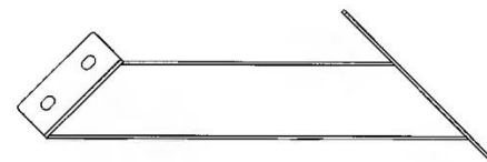
F4 | CALE ANGULAIRE COURTE - A4M01276 (2) | 1 1/8 po x 4 po x 14 po (30x101x355)
