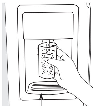
Bac de trop-plein
