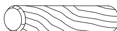
12 WOOD DOWEL/ SERVIETTE EN BOIS/ CLAVIJA DE MADERA x 13 (Ø8 X 30MM)
