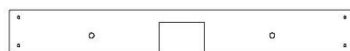
H19 | LISSE DE PLANCHER DU NID-DE-PIE - (1) | W4L15903 1 po x 3 3/8 po x 27 po (24 x 86 x 686)
